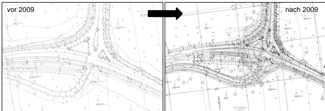
Abb.: Kreuzungsbereich L 601/L 603 vor und nach KVP-Errichtung; Quelle: A16 – aufbereitet durch den LRH
