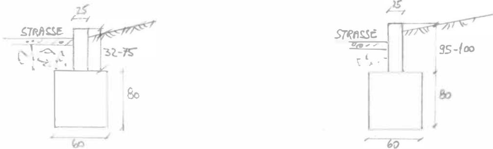
Aus diesen Skizzen ist ersichtlich, daß die der Statik zugrunde liegenden Lastannahmen bei der Ausführung nicht aufscheinen. Auch die Stützmauerhöhen weichen stark von der Ausschreibung (im Mittel 120 cm) und der Berechnung ab.
