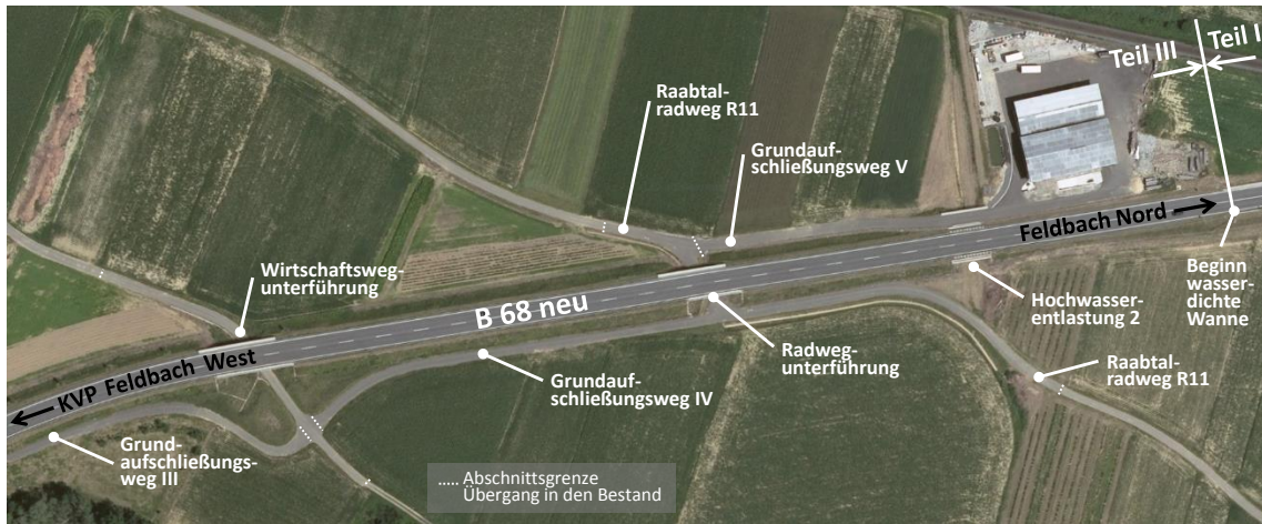
Abb.: Übersicht zum kreuzenden und begleitenden Wegenetz mit den erforderlichen Kunstbauten der B 68 neu im Bereich vor der wasserdichten Wanne (Quelle: GIS Steiermark, adaptiert durch den LRH)
