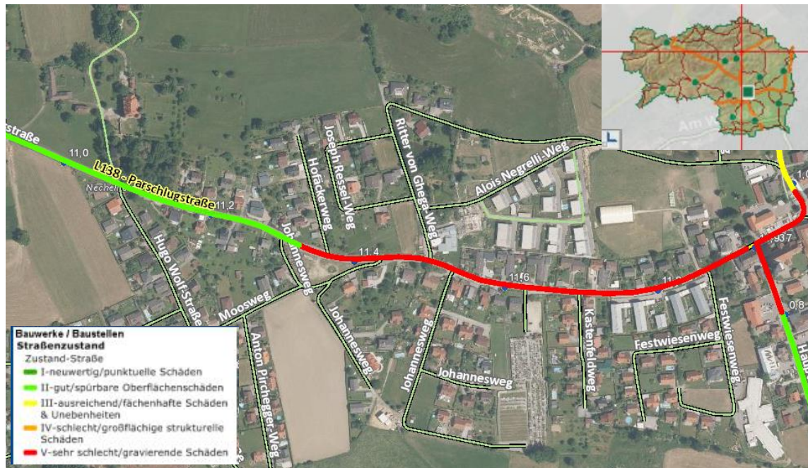
Abb.: Straßenzustand der L 138 von km 11,00 bis km 11,45; Quelle: GIS-Abfrage vom 1. April 2015
