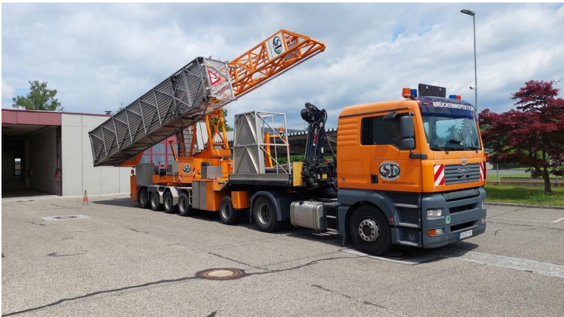
Abb.: Brückenprüfgerät des Straßenerhaltungsdienstes
