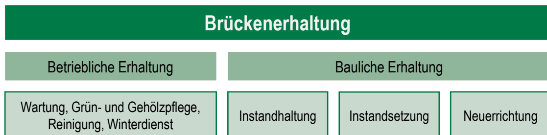
Abb.: Zusammensetzung der Brückenerhaltung
